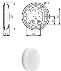
**Technische Daten Philips LED-Wand- und Deckenleuchte Ledinaire WL070V Weiß 20.9W 1700lm - 830 | 285mm - IP65 - Bewegungs- und Lichtsensor**
