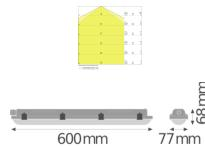
Caractéristiques Ledvance Réglotte LED Étanche Imperméable Value 18W 2160lm - 840 | 60cm
