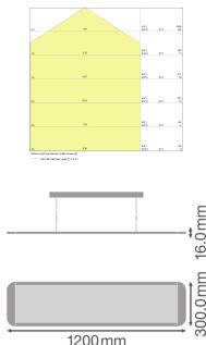
**Caractéristiques Ledvance Dalle LED Suspension luminaire 36W 4000lm - 840 | 120x30cm - Dali Dimmable - Direct/Indirect - UGR <19**
