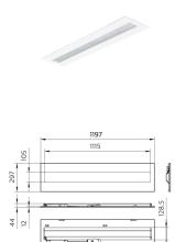
**Caractéristiques Philips Dalle LED CoreLine RC136B 22/31W 3100-4300lm - 840 Blanc Froid | 120x30cm - UGR <19 - Dali Dimmable - Puissance Réglable**
